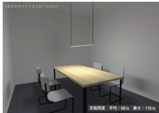
天井からの距離:600mm 光源色:白色4000K 541 lm/1008mm
