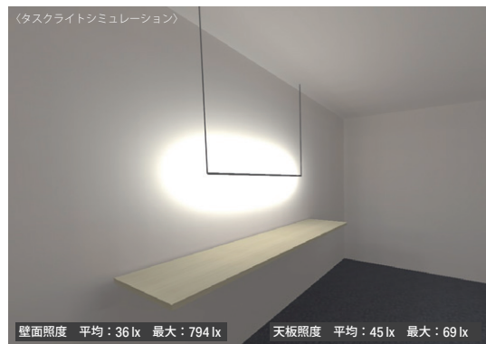
天井からの距離:600mm 光源色:白色4000K 474 lm/1008mm 壁面からの距離:200mm
