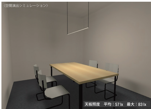
天井からの距離:900mm 光源色:電球色2700K 470 lm/1008mm
