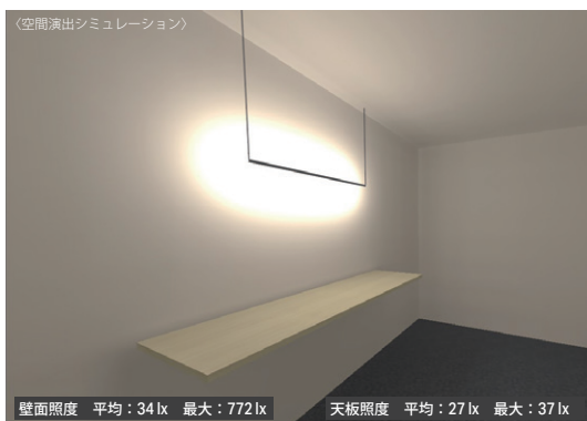
天井からの距離:900mm 光源色:電球色2700K 412 lm/1008mm 壁面からの距離:200mm
