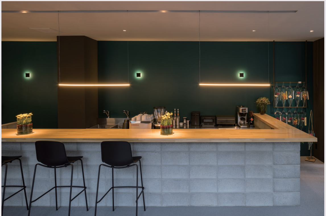
ルーチ・リミット mr ペンダント仕様 P.122 電球色 2700K 直径 8.8 mm の 丸形ドットレスライン照明
