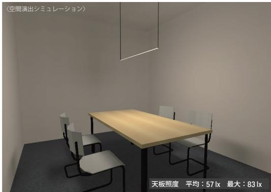
天井からの距離:900mm 光源色:電球色2700K 470 lm/1008mm
