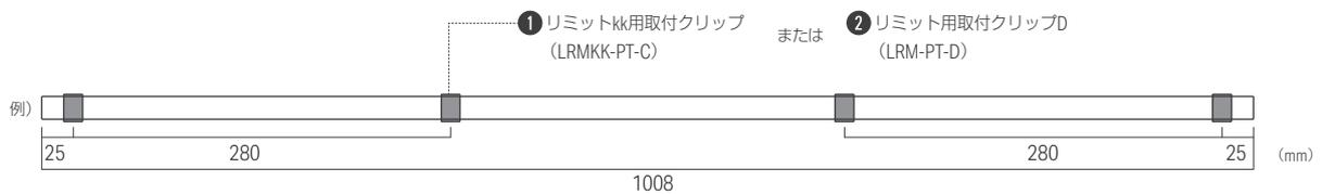
※灯具の長さにより、推奨取付位置(ピッチ:20mm~300mm, 数量:2個~5個)が変わります。詳しくはP.95 特注サイズ一覧表をご覧ください。
