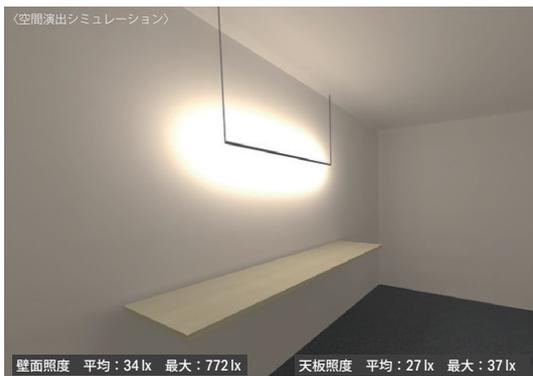
天井からの距離:900mm 光源色:電球色2700K 412 lm/1008mm
