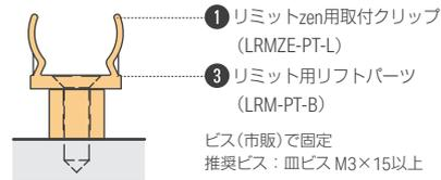
リフトパーツだけでは 灯具の取付は出来ません。必ず、①② いずれかのクリップと併用してください。
