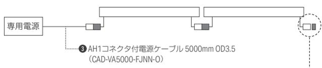
LED 灯具の末端のコネクタは、電源ケーブル付属の **5** AH1 コネクタカバーをしっかりと締め、必ず防水処理をしてください。
