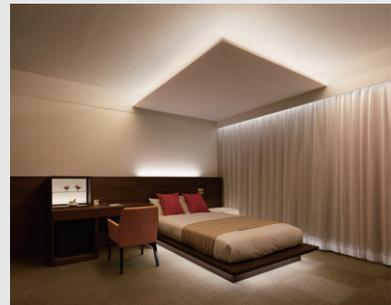
薄い器具を使って幕板なしでも器具が見えず
